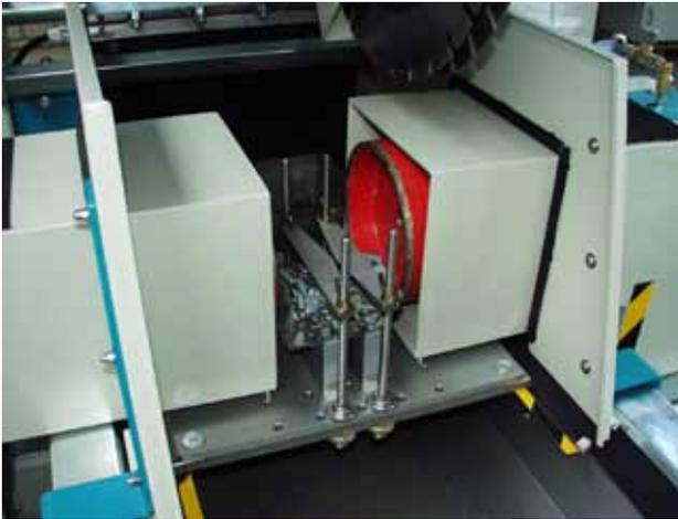
*Exaktes, planparalleles Schleifen einer Rundprobe durch gleichzeitige Bearbeitung von zwei Seiten mit je einem Schleifkopf. Automatischer Vorschub der Schleifeinheiten mit Elektrozyindern*
