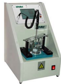
20-2200 Ring- und Kugelautomat Bille Anneau automatique
