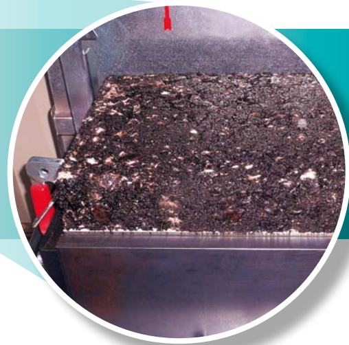
Asphaltprobe beim Entformen Echantillon d'enrobé démoulé
