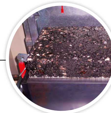
Asphaltprobe beim Entformen
