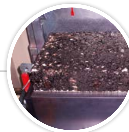
Échantillon d'asphalte déplacé vers le haut pour le démoulage
