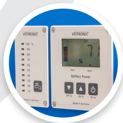
LCD-Display für Wasserfüllstand und Akkuladestand
