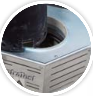
Schmutzfangmatte verhindert das Verunreinigen des Labor-mischers beim Öffnen
