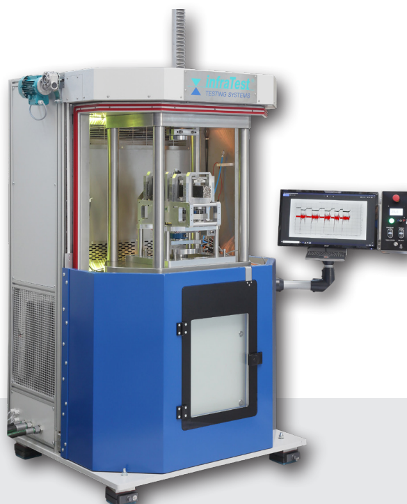
Antriebszylinder von oben wird zwingend benötigt für Schichtverbundprüfungen und TRAVIS
